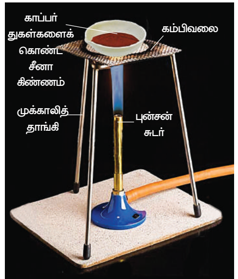
படம்-13(c): காப்பர் ஆக்சைடாக காப்பர் ஆக்சிஜனேற்றம் அடைதல்
